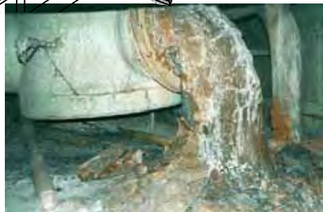
図 12 . 空っぽだった炉心 (上) と溶岩状になって流れ落ちた核燃料 (下) .
