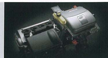
プリウス専用パワーユニット (エンジン、トランスミッション、インバータ)
