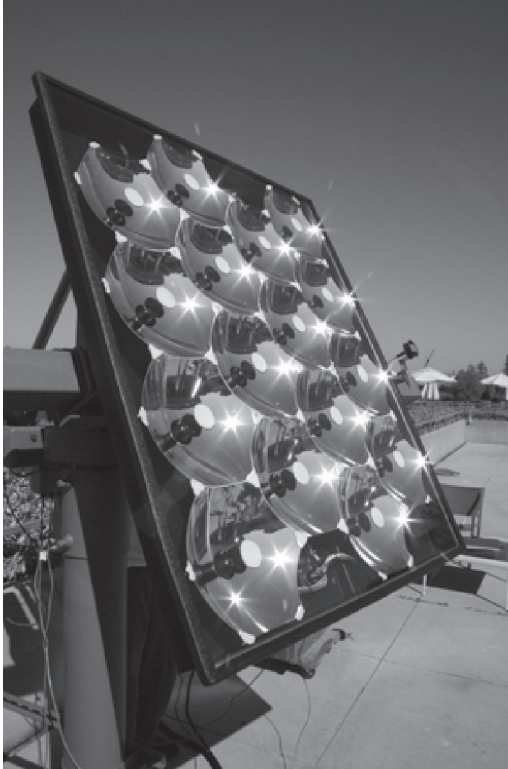
Fig. 14 カセグレレン系集光太陽光発電システム 21)
