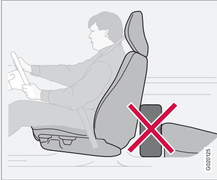
Keine Gegenstände auf dem Boden hinter dem Fahrer-/Beifahrersitz ablegen, die die Funktion des WHIPS-Systems behindern könnten.
