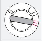
Der Anlasser wird aktiviert. Der Transponderschlüssel wird losgelassen, sobald der Motor gestartet ist, und federt dann automatisch zurück in die Fahrstellung.
