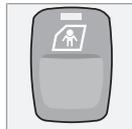
Aktiviert bzw. deaktiviert die elektrische Kindersicherung für die Fondtüren. Der Transponderschlüssel muss sich hierbei in Stellung I oder II befinden.
