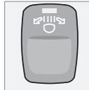
Wenn das Fahrzeug mit aktiven Xenon-Scheinwerfern (Active Bending Lights, ABL) ausgestattet ist, folgt der Lichtstrahl der Scheinwerfer den Bewegungen des Lenkrads während der Fahrt. Die Funktion wird automatisch beim Anlassen des Motors aktiviert und kann durch einen Druck auf die Taste deaktiviert/aktiviert werden. Die Lampe in der Taste leuchtet, wenn die Funktion aktiviert ist
