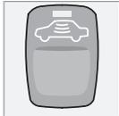
Mit dieser Taste können Sie die Funktion Sicherheitsverriegelung deaktivieren (durch die Sicherheitsverriegelung können die Türen, wenn sie verriegelt sind, nicht von innen geöffnet werden). Auch die Bewegungs- und Neigungsdetektoren Ihrer Alarmanlage\* werden mit dieser Taste ausgeschaltet. Wenn diese Funktionen ausgeschaltet/deaktiviert sind, leuchtet die Lampe, siehe Seiten 139 und 143.
