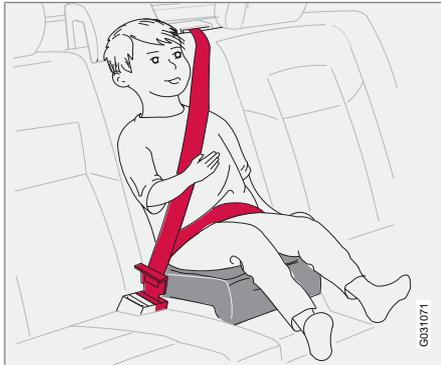
Das integrierte Sitzkissen von Volvo für den mittleren Sitzplatz im Fond weist eine spezielle Konstruktion auf, die eine optimale Sicherheit für Kinder bietet. In Verbindung mit den regulären Sicherheitsgurten ist das integrierte Sitzkissen für Kinder mit einem Körpergewicht von 15 bis 36 kg zugelassen.
