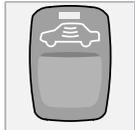
Mit dieser Taste können Sie die Funktion Sicherheitsverriegelung deaktivieren (durch die Sicherheitsverriegelung können die Türen, wenn sie verriegelt sind, nicht von innen geöffnet werden). Auch die Bewegungs- und Neigungsdetektoren Ihrer Alarmanlage\* werden mit dieser Taste ausgeschaltet. Wenn diese Funktionen ausgeschaltet/deaktiviert sind, leuchtet die Lampe, siehe Seiten 124 und 128.
