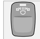
Das Lichtmuster der ABL-Scheinwerfer folgt den Bewegungen des Lenkrads während der Fahrt. Die Funktion wird automatisch beim Anlassen des Motors aktiviert und kann
