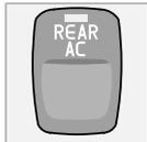
Diese Taste drücken, um die Klimaanlage im hinteren Teil des Fahrzeugs zu aktivieren. Die Klimaanlage im Fond wird beim Abstellen der Zündung deaktiviert.
