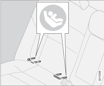
Die Befestigungspunkte für das ISOFIX-Befestigungssystem sind hinter dem unteren Teil der Rückenlehne im Fond, in den äußeren Sitzplätzen, verborgen.
