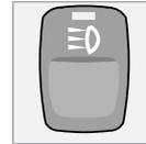
Mit dieser Taste schalten Sie die Zusatzbeleuchtung und das Fernlicht des Fahrzeugs gleichzeitig ein bzw. schalten Sie die Funktion aus.
