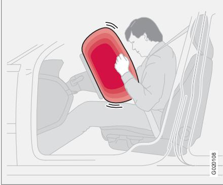
Zusätzlich zum Sicherheitsgurt auf der Fahrerseite hat Ihr Fahrzeug einen Airbag, SRS (Supplemental Restraint System). Der Airbag befindet sich zusammengefoldet in der Lenkradmitte. Das Lenkrad trägt die Kennzeichnung **SRS AIRBAG**.
