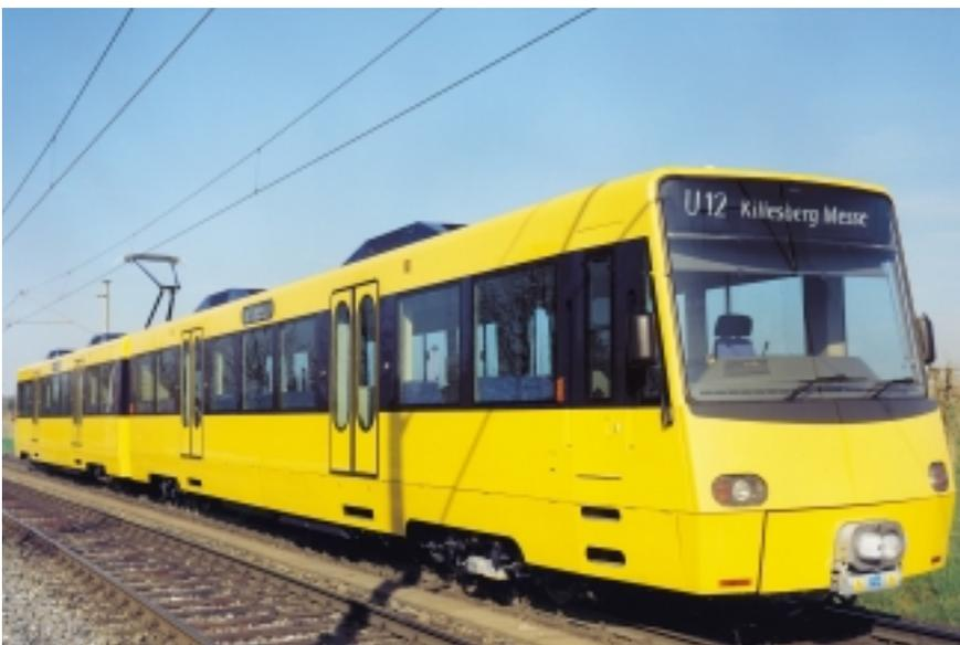
Achtachsiger kurzgekuppelter, mit Übergang ausgestatteter Schnellverkehr-Doppeltriebwagen für Zweirichtungsbetrieb mit Mikroprozessorsteuerung.
