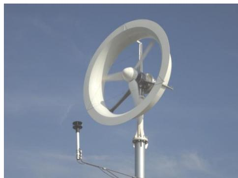
図3 レンズ付き風車 (1kW)
