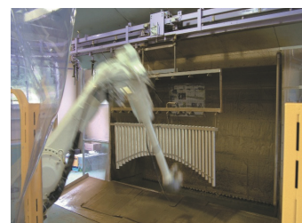
塗装工程を無人化した塗装ロボットの導入
