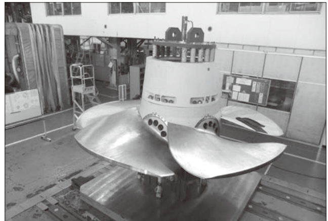
図 54 31.4MW立軸バルブ水車用ランナ (製作中)
