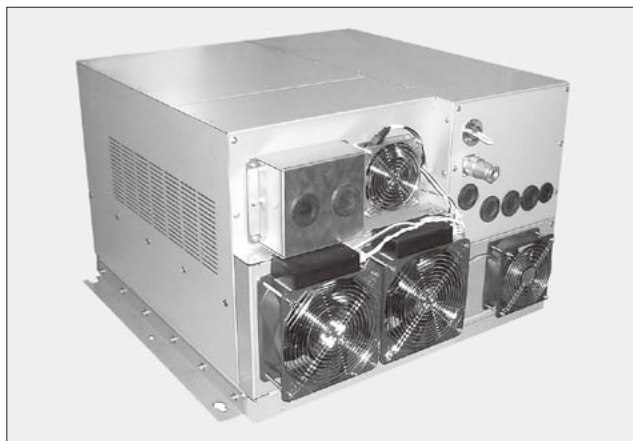
図35 IHインバータユニット（50kW）
