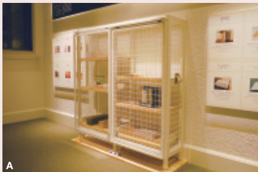
A) 本館17室の「収納棚」 B) 棚の下には清掃用の空間を設けています C) 資料の落下を防ぐ金網戸
