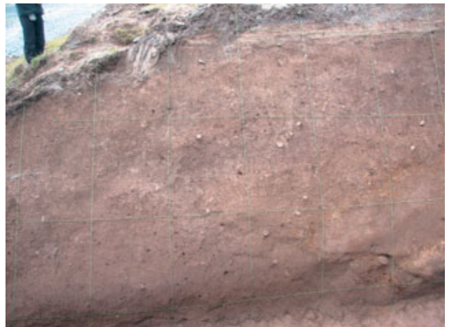
図3 タンダ断層北西端でのトレンチ位置 (左) とその西側断面 (右)。左の写真では、トレンチの手前に断層の末端の亀裂が見える。右の写真では右下から左上に上がっていく断層が見える。水糸の間隔は1m。
