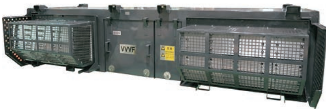
■ 図2 VVVFインバータ装置 Fig.2 Propulsion inverter
