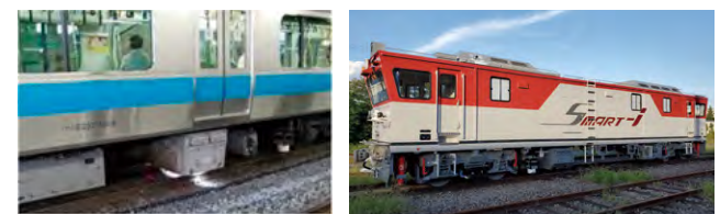
線路設備モニタリング装置(在来線)
