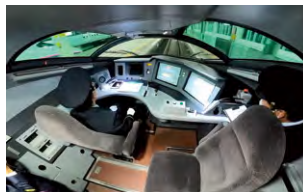
回送列車自動運転の実証試験の様子
