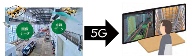
5Gやデジタルツインを活用したリモート施工監督のイメージ
