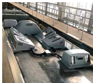
架線設備モニタリング装置を搭載した電気・軌道総合検測車(East-i)
