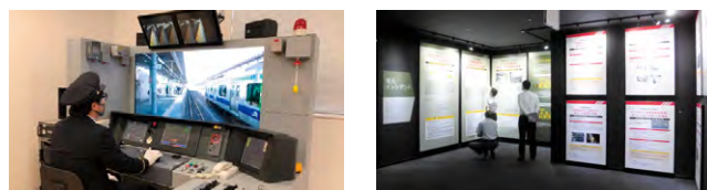
実映像を用いた臨場感ある乗務員訓練用シミュレータ
