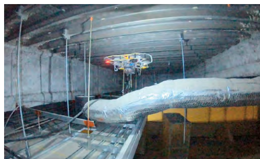
人の立入りが困難な現場などで、狭小空間専用小型ドローンを用いて、画像や点群を取得
