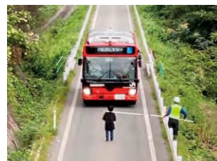
専用道入立入りを想定した自動停車試験
