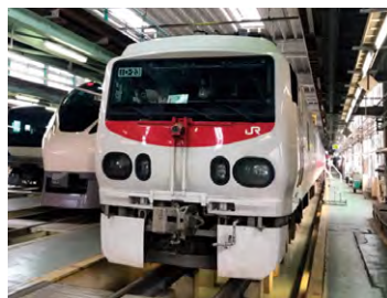
架線設備モニタリング装置を搭載した電気・軌道総合検測車(East-i)
