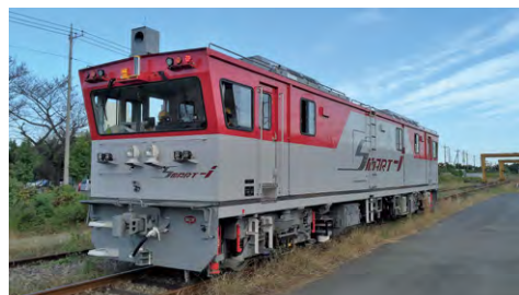
新幹線線路設備モニタリング装置を搭載した専用保守用車(SMART-i)
