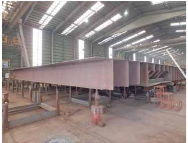
写真3 船内隔壁ブロック
