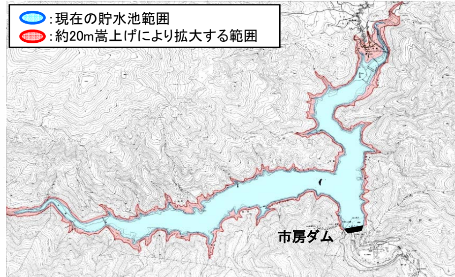
既設コンクリートダムの嵩上げ実績
