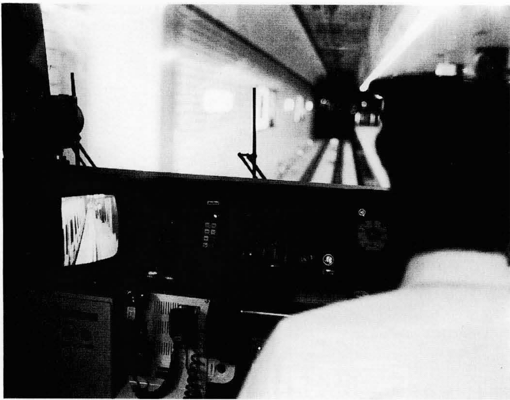
図7 列車の運転室 左側にホーム画像監視用のモニターが、またその上に受光器が見える。
