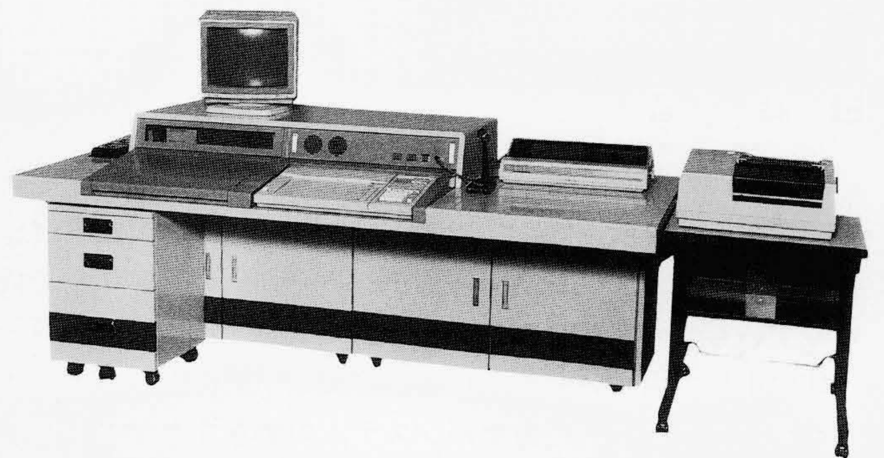
図13 車両検修システム操作卓 中央部にコードセクタを、左にパーソナルコンピュータとハンディターミナルを、右にプリンタとカラーハードコピーを配置している。
