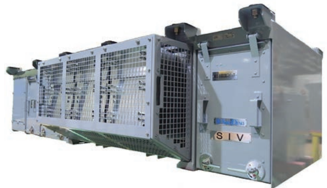
■ 図3 SIV装置外観 Fig.3 Static inverter
