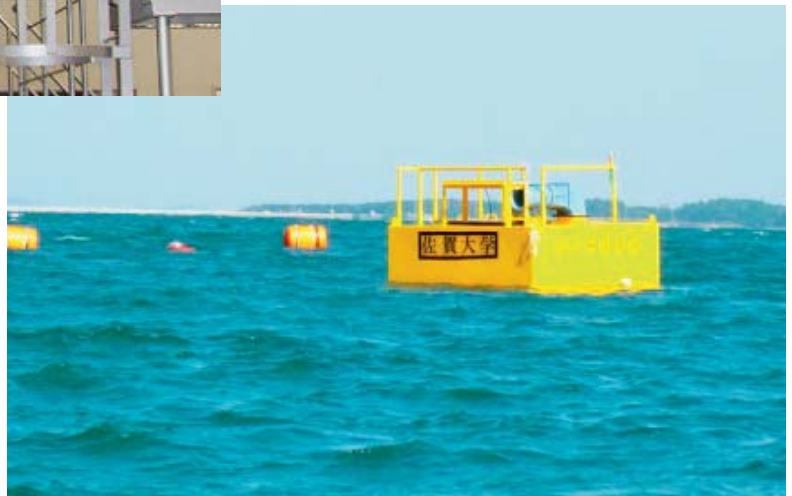
波力発電装置の博多湾での実海域実験
