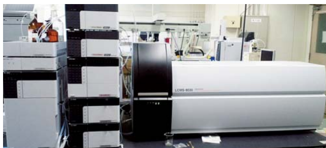
超高速トリプル四重極型質量分析計 (機器分析部門・鍋島地区)
