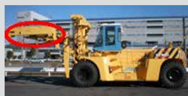
トップリフターもスプレッド部で4点の重量を測定
