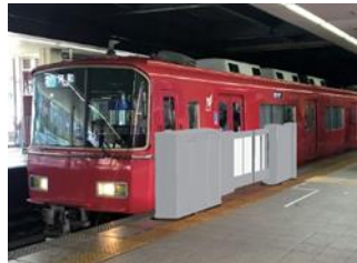
実証試験ホーム柵設置イメージ
