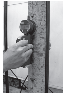
写真3 モルタルおよびコンクリートの長さ変化測定状況 (ダイヤルゲージ方法)
