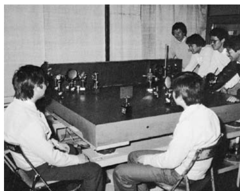
レーザーによる変形測定（ホログラフィー）
