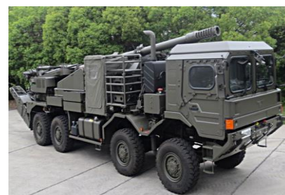
19式装輪自走155mmりゅう弾砲 (試作品)
