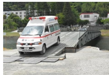
07式機動支援橋 (救急車の通過【防災訓練】)
