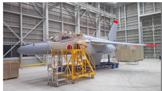
図2 静的計測用T-4目標 松島基地で津波により被災した機体を活用
