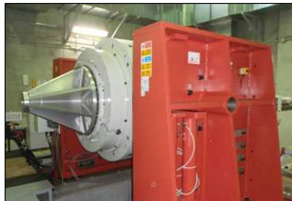
図3 振動試験の試験装置(加振器)
