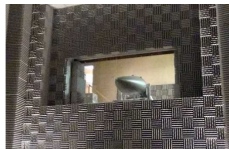
写真1 レーダ電子戦シミュレータにおいて性能確認試験中の先進統合センサ
