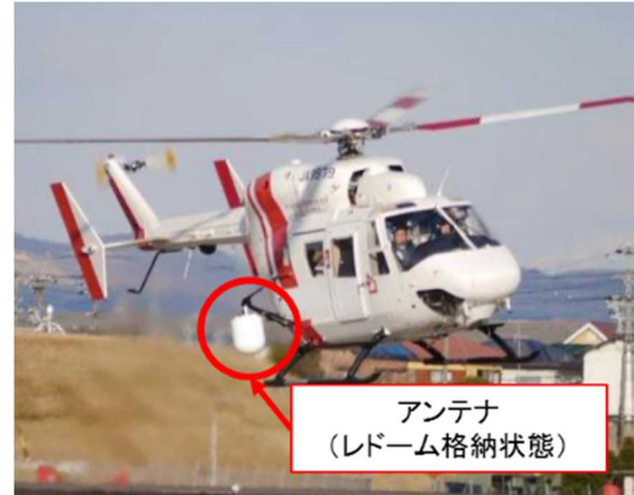
図1 機体搭載の様子 (提供: セントラルヘリコプターサービス株式会社)
