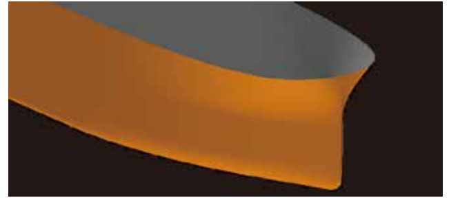
第5図 バルブレス船首形状（38BC）
