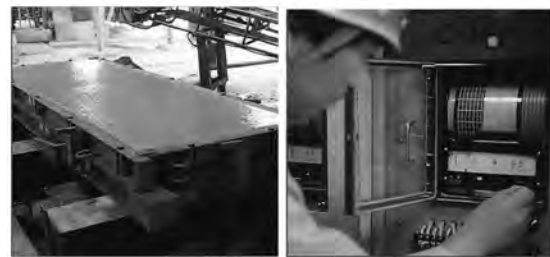
③振動締め固め ④蒸気養生のための蒸気温度管理
