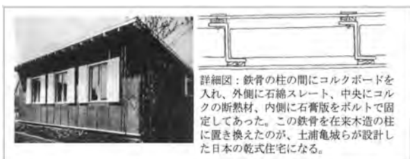
図 1.2 トロッケン・モンタージュ・バウ *2 とそのパネル断面
