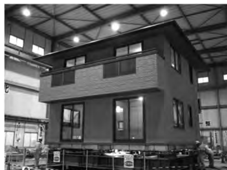
図 4.8 振動台における実大振動実験の試験体例
