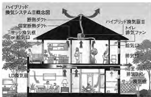
図 3.29 換気システム例 *3
