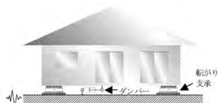
図4.3 免震の仕組みの一例
