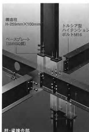
図 2.51 柱 - 梁接合部 (積水ハウス) *26
